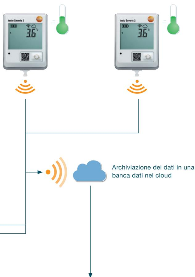
Come funziona il sistema? Uno o più data logger WiFi (che puoi combinare a piacere) rilevano automaticamente i dati e li trasmettono tramite la rete WLAN a un archivio online, il Testo Cloud.
